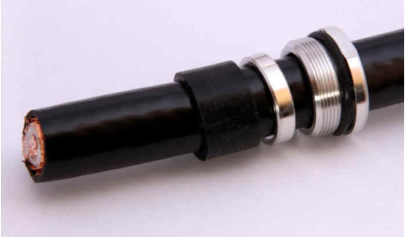
Schneiden Sie das Kabelende mit einem Koaxschneider rechtwinklig ab. Der Innenleiter muss dabei absolut rund bleiben. Sollten Sie keinen Koaxschneider zur Verfügung haben, können Sie auch eine feine Metallsäge nehmen.
